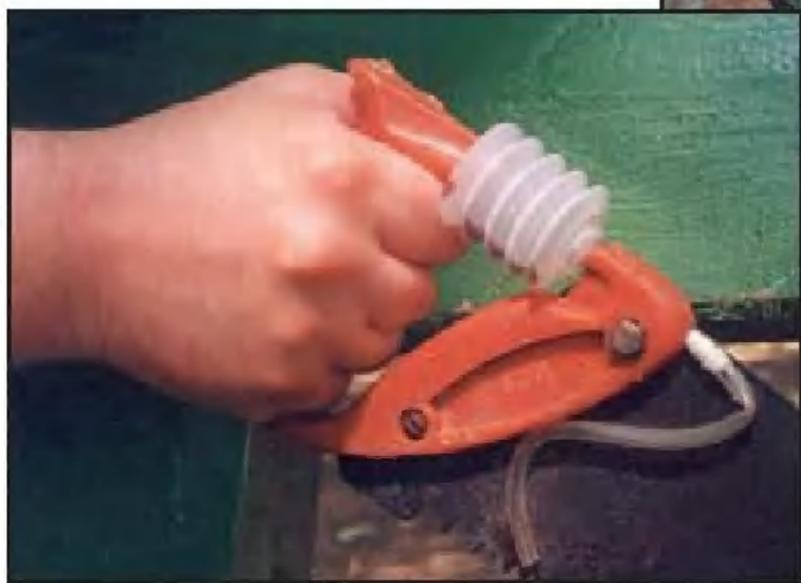
рукоятка закреплена на упругом кронштейне и имеет воздушный сильфон. Идет ножовочное полотно вниз — сильфон сжимается и воздушная струя сдувает опилки с доски. При ходе полотна вверх сильфон вновь наполняется воздухом.
