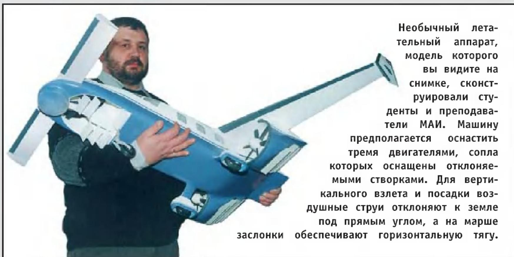
Необычный летательный аппарат, модель которого вы видите на снимке, сконструировали студенты и преподаватели МАИ. Машину предполагается оснастить тремя двигателями, сопла которых оснащены отклоняемыми створками. Для вертикального взлета и посадки воздушные струи отклоняют к земле под прямым углом, а на марше заслонки обеспечивают горизонтальную тягу.
