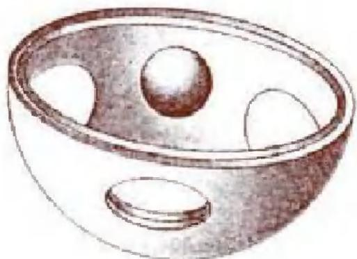
Устройство лазерной мишени. Полимерная капсула с изотопами водорода окружена двухслойной оболочкой. Снаружи мишень покрыта медью или полимерной пленкой толщиной 10 — 15 мкм, изнутри — более толстым слоем железа, золота, индия или алюминия. Лазерная вспышка испаряет металл, и его пары сжимают капсулу, инициируя термоядерную реакцию.
